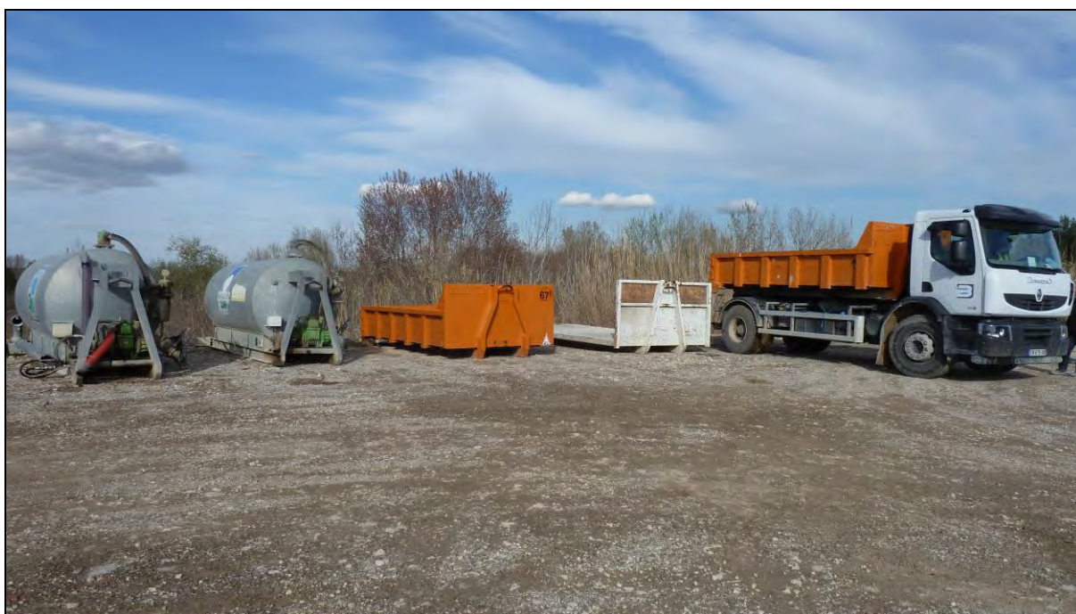
Plateforme de stockage des bennes de location et citernes pour arrosage du site à gauche
