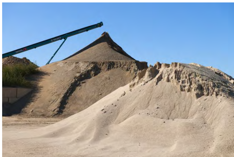
3 – Terres et sables recyclés issus du recyclage de gravats terreux
