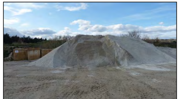
4 – Graves béton recyclées
